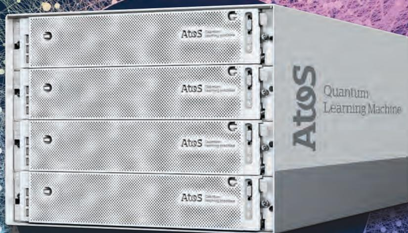
**Bild 1:** Die Atos Quantum Learning Machine ist ein Quantensimulator, der bis zu 41 Qubit zur Verfügung stellt. Mit dem System können Nutzer Quantensoftware für unterschiedliche Einsatzszenarien entwickeln und testen.
